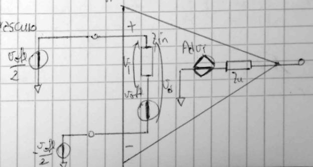
è la sola  $v_i$  se cade su  $Z_{in}$ , non l'intera  $v_o = v_{off} + v_i$ !
