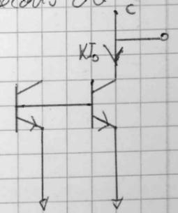
stadio di amplificazione; tra il primo e il secondo abbiamo tirato su per bene la tensione; serve uno stadio finale che permetta all'operatore di pilotare un carico, dunque uno stadio di potenza (tipo un source-follower!)
