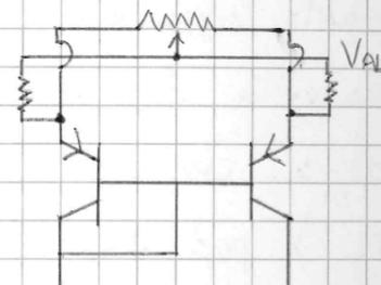
Per fare ciò, porto "fuori" i terminali e dall'esterno attacco un potenziometro con cursore collegato all'alimentatore. Variando la posizione del cursore vario le resistenze viste, dunque il rapporto di spezzamento! Ancora, muovo l'usata dopo aver messo a 0 gli ingressi, e quando l'usata va a 0, il potenziometro va bloccato. Ho due resistenze "extra" non messe in modo da, se non molto il potenziometro esterno, il circuito funziona lo stesso.
