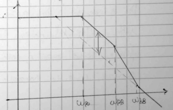
Questa coppia polo/zero introduce per un'ottava un guadagno di  $-40 \text{ dB/dec}$  o  $-12 \text{ dB/ottava}$ , dunque si perdono  $6 \text{ dB}$  in più rispetto al caso in cui la coppia non vi fosse.
