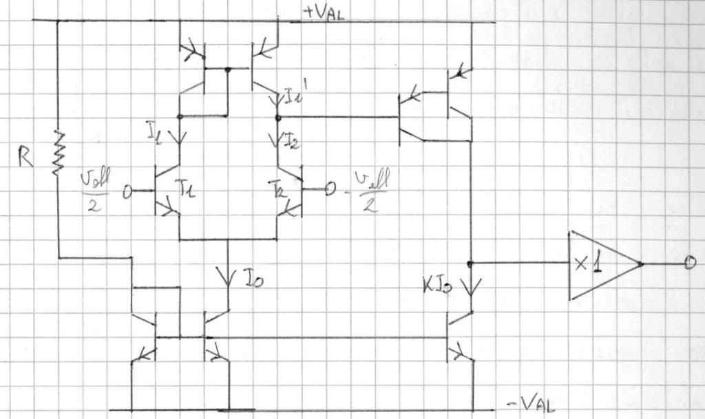
In questo ambito, l'offset è la tensione che devo applicare all'ingresso al fine di ottenere l'uscita nominale (ovvero, 0!). Nel nostro circuito, i contributi di offset sono sostanzialmente di due tipi: uno "strutturale", intrinseco della struttura, e uno dovuto alle tolleranze sui componenti.
