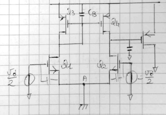
al centro a destra la tiro qui della stessa quantità, ma dunque il punto centrale è immutato, dato la simmetria nel circuito. Per il segnale differenziale dunque A noi cambia di tensione, e dunque è come se fosse al potenziale di riferimento.
