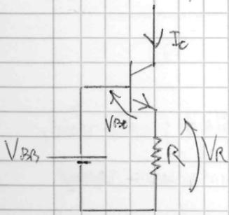
e mettò una resistenza  $R$  sull'emettitore, ad che capita è che anche la tensione  $V_E$  è fissata!
