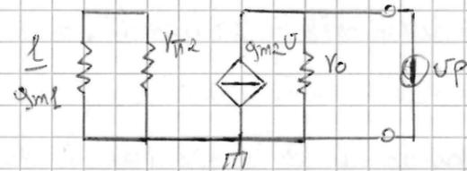
Dalla base, il transistor destro vede, approssimando,  $\frac{1}{g_m}$ ; però, del momento che  $v_{\pi 2}$  è tra 0V e  $\varphi$ , abbiamo che la corrente
