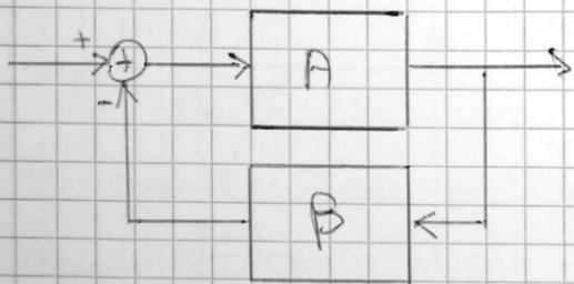
Ho un segnale di errore  $E$  che pilota l'uscita attraverso l'amplificazione; un esempio di ciò è il servosterzo: la retroazione consiste nel misurare la posizione delle ruote mediante un trasduttore, riportando indietro, calcolando l'errore e mandando per pilotare le ruote in modo da annullarlo.
