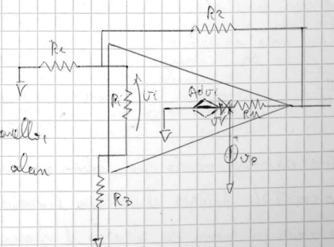
Per  $\beta$ , posso fare un ragionamento particolare: siccome non conosco  $R_i$  e  $R_{u1}$ , per "mettermi al sicuro", posso ipotizzare che l'amplificatore sia nel peggior caso possibile, e stimare un  $|T|$  più grande del dovuto.
