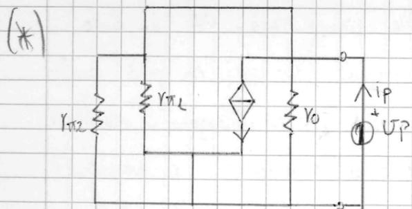
il pilotato,  $r_o$ ,  $r_{\pi}$ , in realtà vi è anche un quanto contribuito, internamente il "carico" della base, la quale "vede"  $r_{\pi 2}$ .
