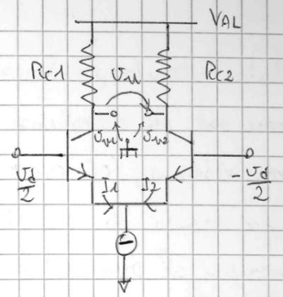
$$\begin{cases} v_{u1} = V_{AL} - \left[ \frac{I_0}{2} + g_{mo} v_d \right] R_c \\ v_{u2} = V_{AL} - \left[ \frac{I_0}{2} - g_{mo} v_d \right] R_c \end{cases}$$
