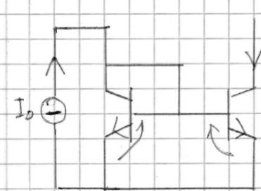
potrei fissare  $V_{BE}$ , ma in un modo intelligente: se forzo in un transistor una corrente  $I_0$  mediante un generatore "ideale", quello che faccio è collegare
