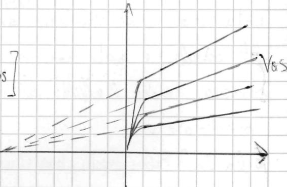
Alcune note: il termine  $\mu_n \frac{C_{ox}}{2}$  è di solito chiamato  $K_n$ ; nei datasheet non si sa se chiamare  $\mu_n C_{ox}$  o  $\frac{1}{2} \mu_n C_{ox} K_n$ , dunque si ha un po' di indeterminazione.  $W/L$  è detto "termino di aspetto", ed è progettato dal progettista;  $V_{th}$  è la "tensione di soglia" e dipende dalla tecnologia;  $V_{th} \approx 0,8V$ , ma si tende ad abbassarla.
