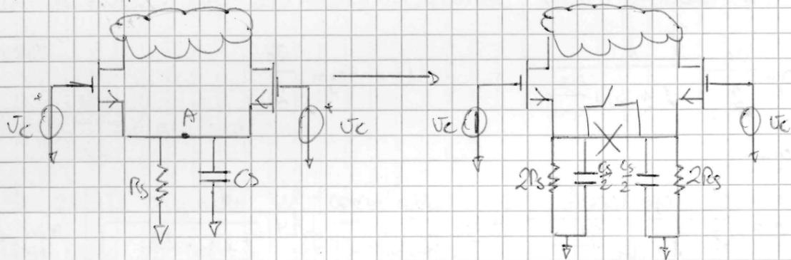
Questo circuito può essere pensato mettendo in parallelo  $2R_s$  e  $2R_s$ , e  $\frac{C_s}{2}$  e  $\frac{C_s}{2}$ ; le correnti sui due rami "sotto" saranno uguali, dunque in quello che abbiamo sempre chiamato "A", di corrente non ne passa. Per questo è lecito "aprire" il collegamento, e separare questi due sotto-rami "X" (indica l'area aperta il circuito).
