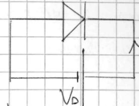
Combinando  $V_0$  la corrente non cambia, perché il numero dei minoritari non dipende da essa, quanto dai drogaggi e soprattutto dalla temperatura, o da altri meccanismi di iniezione (come la generazione ottica).
