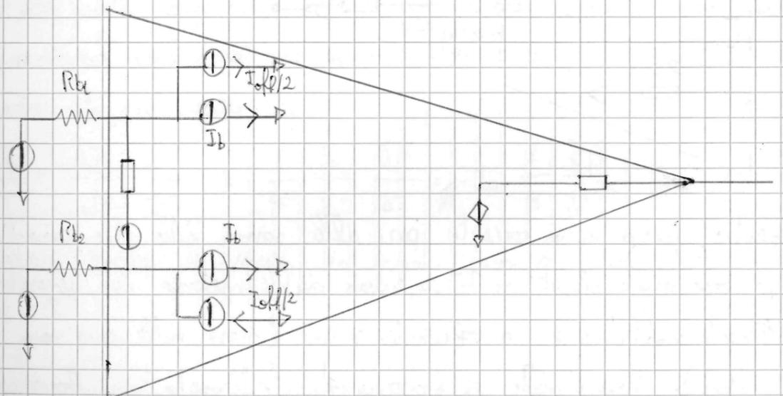
In questo modo una volta  $\frac{I_{off}}{2}$  si somma, una volta si sottrae a  $I_b$ .  $I_b$  è la "media" delle correnti di base, mentre  $I_{off}$  è lo sfasamento rispetto alla media.
