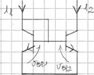
Dal momento che  $V_{BE1} = V_{BE2}$ , se i due transistor sono uguali,  $i_1 = i_2$ ; si può anche definire un "rapporto di specchiaggio", a partire dal rapporto delle aree.
