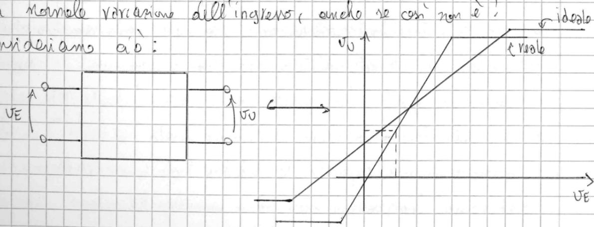
Si ha una retta indicante la caratteristica ideale dell'amplificatore; la cosa brutta è che ciascun dispositivo (anche della stessa serie!), a causa delle tolleranze di fabbricazione, ha una retta-caratteristica diversa da quella ideale: una caratteristica reale.
