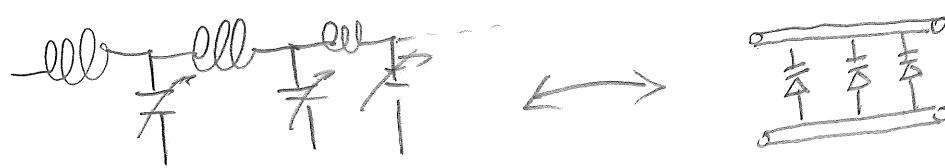
Linea di Tx carica su variator, con  $V_f$  variabile. A seconda del valore della tensione su ciascun punto della linea, si fa propagare il segnale con una  $V_f$  diversa.  $V_f = \frac{L}{VLC}^{\frac{1}{2}}$ ,  $C \propto V^2$  dunque con  $V$  più grande il segnale verrà rallentato, con  $V$  più grande verrà velocizzato.
