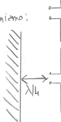
L'asse del dipolo coincide con quello della schiera di 4 elementi. Il piano E per la schiera è l'asse della schiera; la direzione di irradiazione broadside sarà l'asse dell'altra schiera, ossia la normale all'asse dei dipoli;
