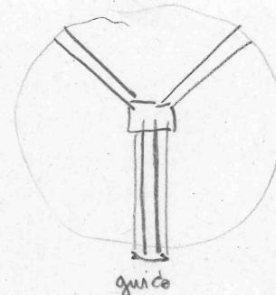
$$\text{Bloccaggio centrale: } \Delta G_{dB} = -8,7 \times \left(\frac{d}{D}\right)^2 \approx 0,01 \text{ dB}$$
